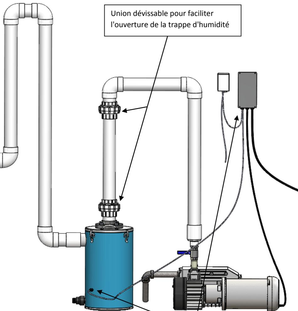
**Flotte pour arrêt de pompe s'il y a accumulation d'eau**
