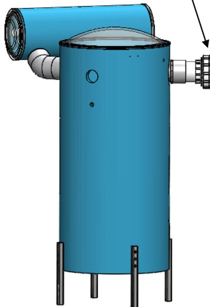
Union dévissable pour faciliter l'ouverture de la trappe d'humidité
