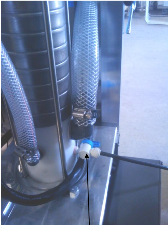
Photo 8 Valve de drainage de la turbine
