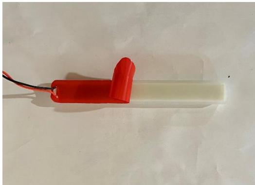
Coller le LED sur la surface nettoyée, à l'emplacement préalablement choisi. Appuyer fermement sur le LED afin de s'assurer qu'il est bien collé. Ensuite, passer le fil dans le trou ¼.
