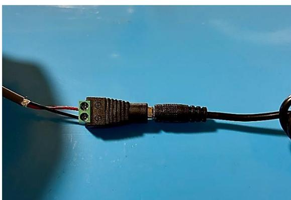
Étape 10 – Vérifier la fonctionnalité de la lumière LED en connectant le transformateur à une source 110 volts
